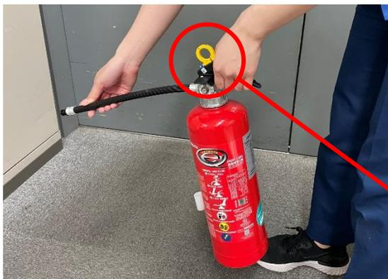
※居室内でデモンストレーションを実施する際は、実際に噴射しないよう黄色の安全ピンを抜かずにホースのみ操作します。
